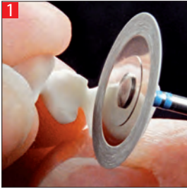
1 Обработка оксид-циркониевой керамики. Trimming of sintered zirconia.
