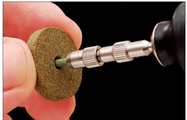
Правильный камень P1108, специально для NTI Point полиров. Dressing Stone P1108 for shaping and pointing of polishers.
