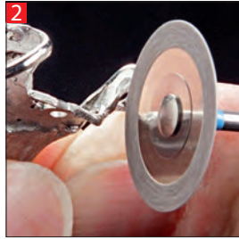
2 Обработка металлических каркасов. Trimming of metal framework.
